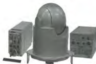
Станция оптико-электронного подавления
